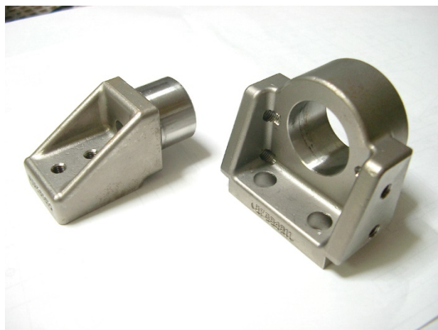
用途 半導体製造装置 材質 ステンレス鋼
