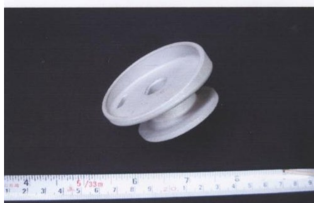
用途 新幹線車両 材質 アルミニウム合金
