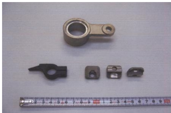
用途 印刷機部品 材質 特殊鋼
